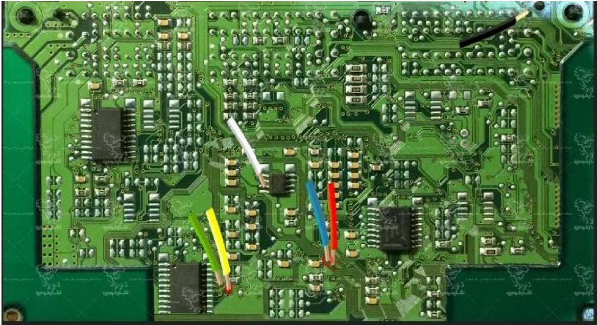
نمای کلی اتصال سیم های فلت رنگی به ایسیو بوش ۷،۴،۹
