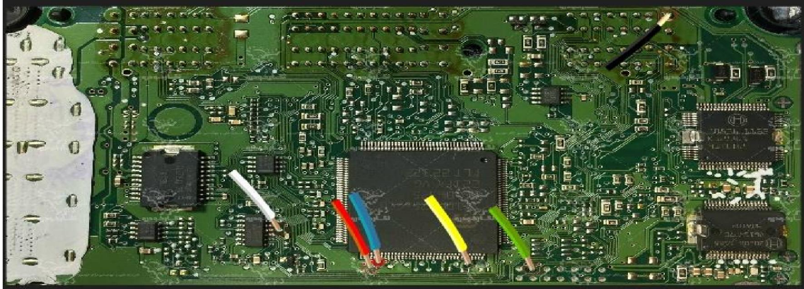
نمای کلی اتصال سیم های فلت رنگی به ایسیو بوش ۷،۴،۵
