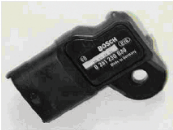
حس گر فشار مطلق هوای مانیفولد ورودی و درجه حرارت هوای ورودی
